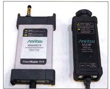
USB-Leistungsmesser für 9 kHz bis 70 GHz und VNWA für 150 kHz bis 6 GHz – beide von Anritsu Fotos: DL2MCD
