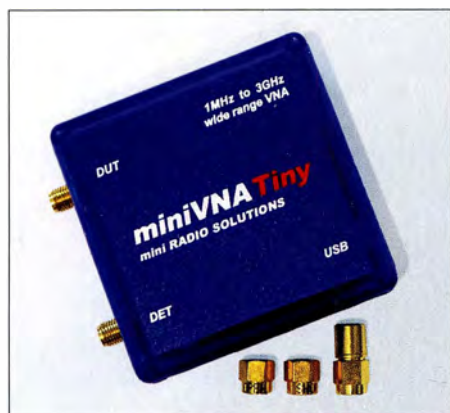
Bild 1: miniVNA Tiny mit den Kalibrierelementen (Open, Short, Load)
