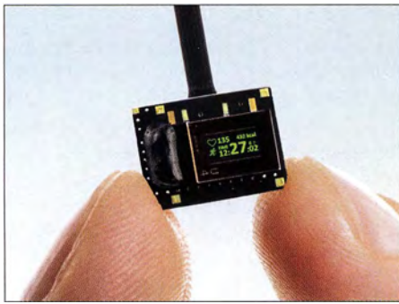
Steuerschaltkreis nebst aufgetragenen OLEDs der Datenbrille des Fraunhofer FEP
