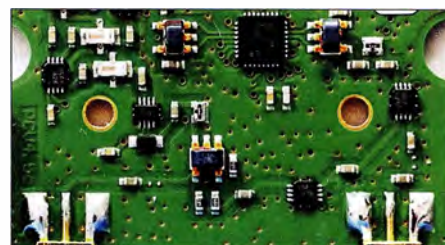
Bild 3: Leiterplattenausschnitt mit den SMA-Buchsen unten, der Messbrücke und den Schalter-ICs
