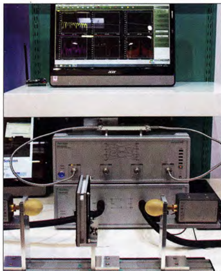
Die Materialmesstrecke von Anritsu analysiert die HF-Eigenschaften im E-Band.
