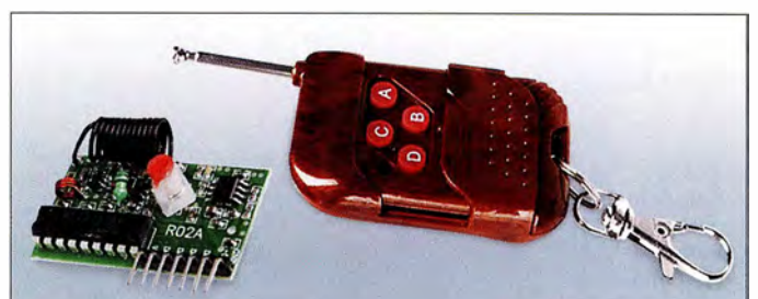
Bild 1: Die Fernsteuerungssets von Winomo und Pixnor enthalten jeweils einen Handsender mit vier Tasten und einen Empfänger mit herausgeführten Signalleitungen. Fotos: Urbanneck
