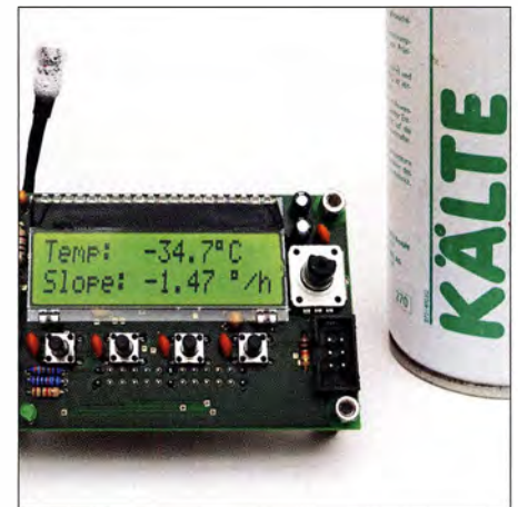
Bild 7: Der Test mit Kältespray zeigt, dass auch negative Werte angezeigt werden.
