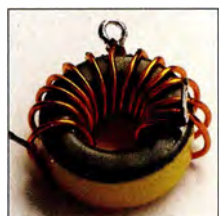
Bild 4: Zum Einbau vorbereitetes Bauteil L3
