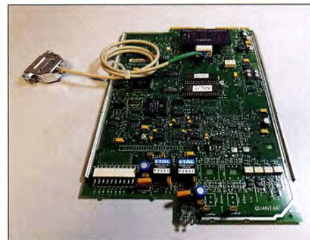
Hardware für das Exzenterhaus DB0BS; Wireline-Board mit Firmware, Aufsteckboard von DC5AJ, Kabel zum Cisco-Router Fotos: DL1YBL
