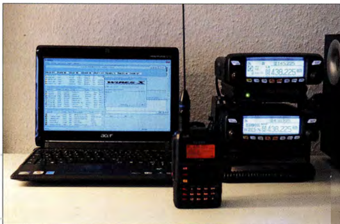
Bild 1: WIRES-X-Station mit Computer, Interface HRI-200 und einem C4FM-Fusion-Transceiver. Ein zweites Digitalgerät steht für C4FM-Fusion-QSOs bereit, ein herkömmliches Handfunkgerät für FM.
