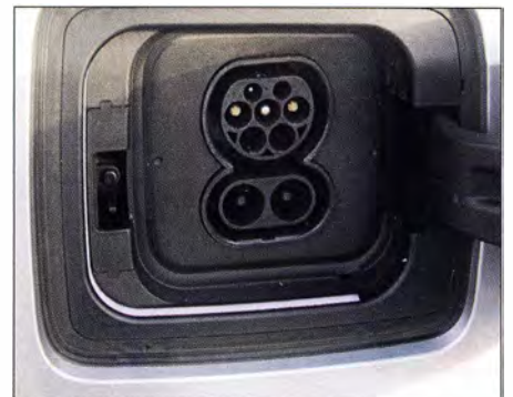
Kombi-Ladeanschluss am BMW i3 für Wechselstrom- und Gleichstrom-Schnellladung
