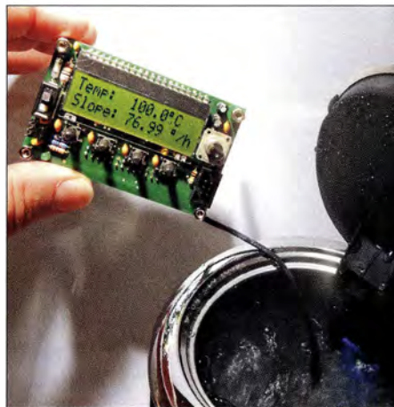
Bild 6: Der Sensor wird hier in siedendes Wasser gehalten.
